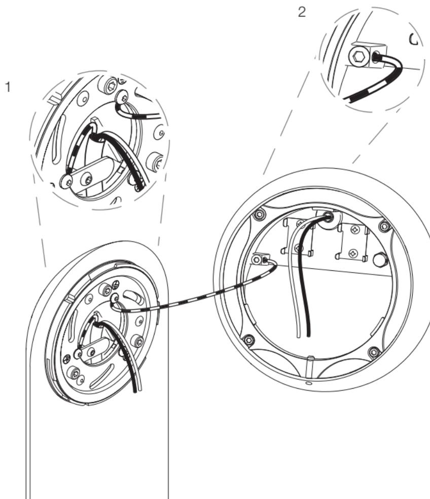
Beide Kabel (max. 1,5 mm<sup>2</sup>) bis zum Anschlag in die Klemme schieben und die blaue Kappe nach unten drücken, die Kabel werden dabei autom. abisoliert.
