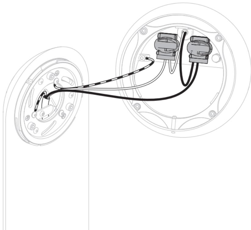
Keine Kabel bei der Befestigung einklemmen!
