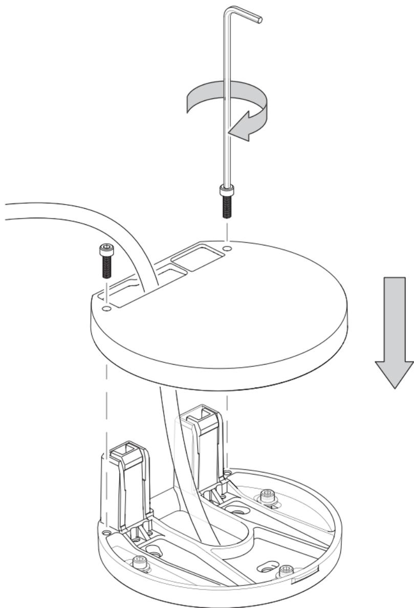
Kabel durch die mittlere Öffnung schieben und zugentlasten.
